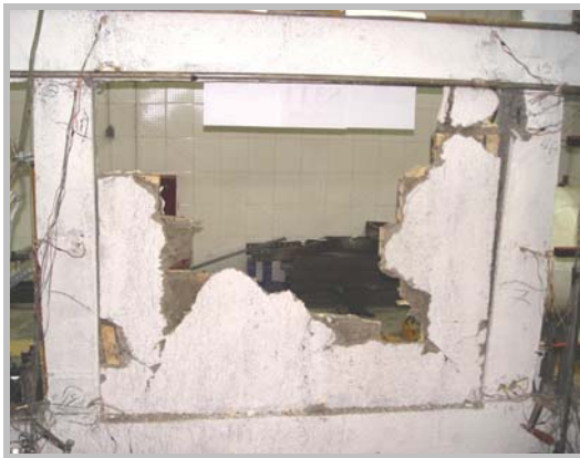
شکل ۱۱: الگوی ترک خوردگی در قاب دارای میان قاب سفالی.
