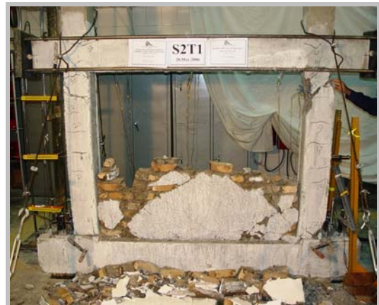
شکل ۱۰: الگوی ترک خوردگی در قاب دارای میان قاب آجر فشاری.
