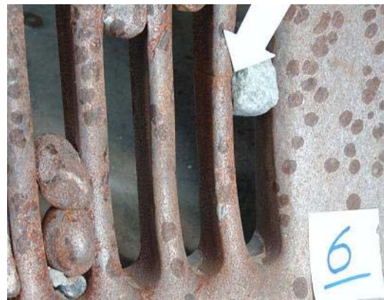
شکل ۱۳: شکست صفحات جداکننده سوراخ‌ها در شبکه.
