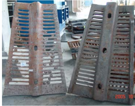
شکل ۴: مقایسه شبکه نو و از کار افتاده (سمت راست: تصویر شبکه نو. سمت چپ: تصویر شبکه از کار افتاده بعد از ۶۲۰۰ ساعت کارکرد).
