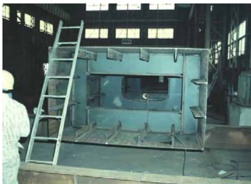
شکل ۵: مقطع یک ستون جعبه‌ای با سخت‌کننده‌های طولی و دیافراگم‌های عرضی.
