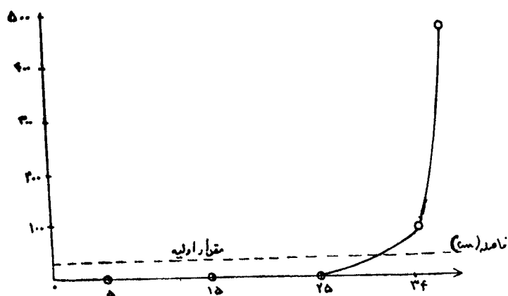
شکل ۲- تغییرات غلظت نقره در میله‌ای از قلع بر حسب فاصله از سر میله و بعد از ۹ بار تکرار عمل ذوب منطقه‌ای.
