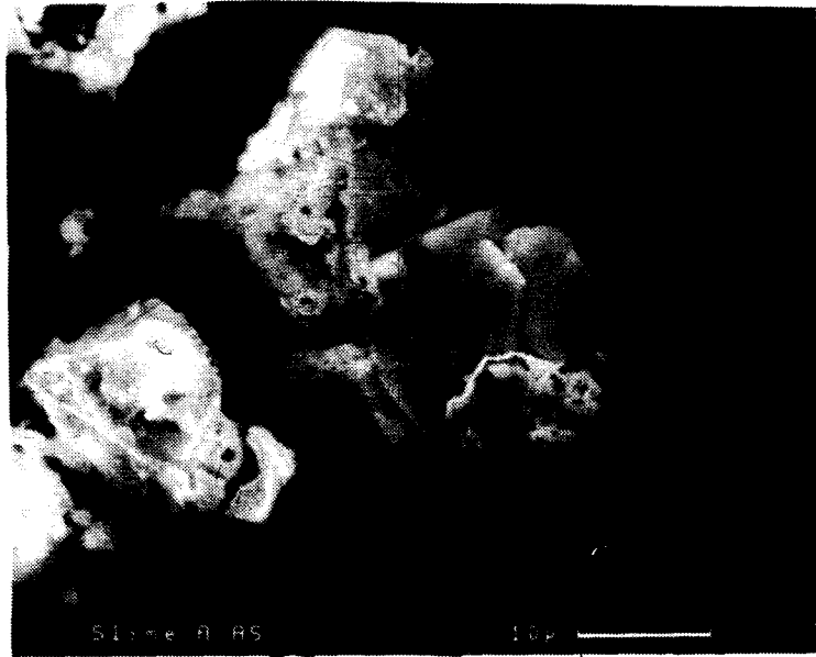
شکل ۱: ترکیب As_2O_3 در لجن الکترولیز: توسط میکروسکپ الکترونی
