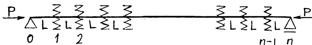
شکل ۱ - تیر روی تکیه گاههای ارتجاعی منظم تحت بار محوری فشاری
