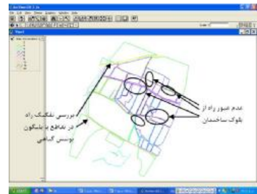
شکل ۱۰: فایل dxf عوارض رقومی شده راه و غیر راه در محیط نرم‌افزار ArcView و چند نمونه کنترل عوارض
