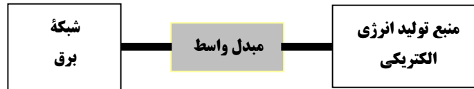
شکل ۱: نقش مبدل واسط الکترونیک قدرتی در اتصال منبع تولید انرژی الکتریکی به شبکه برق.
