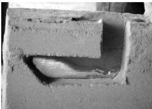
شکل ۱۰: چگونگی جریان مذاب در راهبار در آزمایش ۴ (با وجود فیلتر). مذاب پس از برخورد با انتهای راهبار به صورت آرام به سمت بالا حرکت کرده است.
