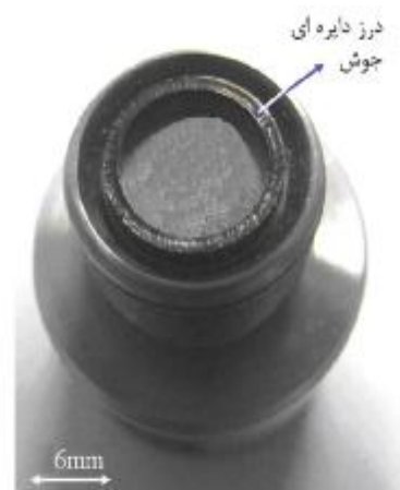
شکل ۱: نمونه جوش کاری شده فولاد شماره ۱.
