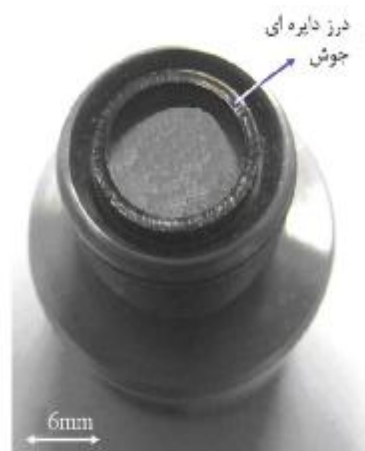
شکل ۱: نمونه جوش کاری شده فولاد شماره ۱.
