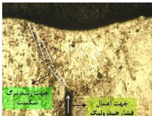
شکل ۱۹: مکانیزم شکست نمونه‌ها در حالت کلی.
