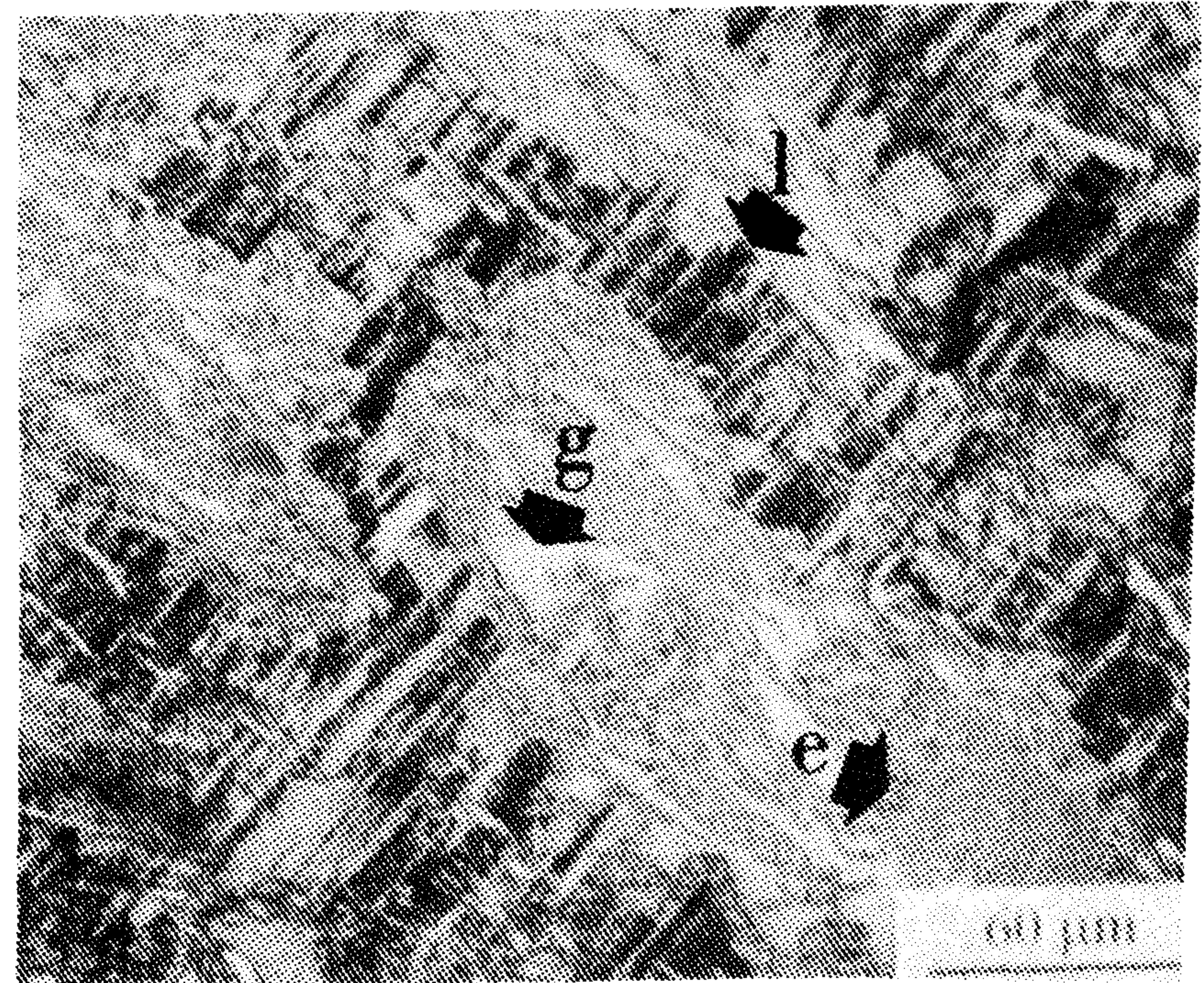
شکل ۱: ساختار ریختگی آلیاژ A1؛ 1 = ساختار لایه ای. g = \text{فاز } \gamma ؛ e = \text{ساختار یوتکتیک} .
