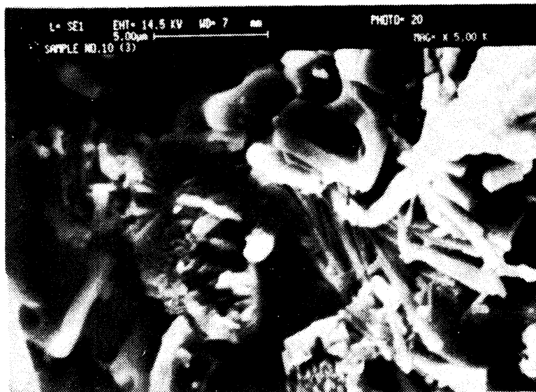
شکل ۷: آنالیز SEM جهت نمایش کریستالهای SrSO 4 در میانه مغزه و دمای مخزن (۱۰۴ °C).
