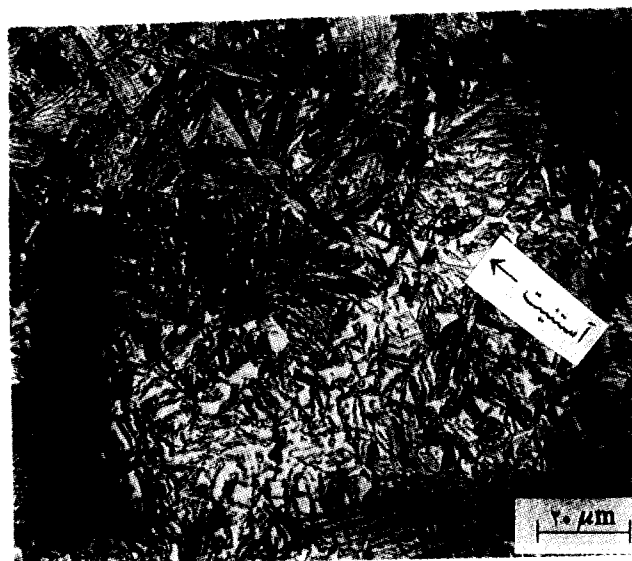
شکل ۳: تصویر میکروسکوپی ریزساختار نمونه چدن نشکن آستمپر شده در دمای 350^{\circ}\text{C} بمدت ۲۴۰ دقیقه، محلول اچ: نیتال ۲٪.
