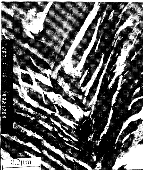
شکل ۵: تصویر میکروسکوپ الکترونی عبوری (DF) از برگشت (۲۰۰) استنیت نمونه استمپر شده پی در پی [۷].
