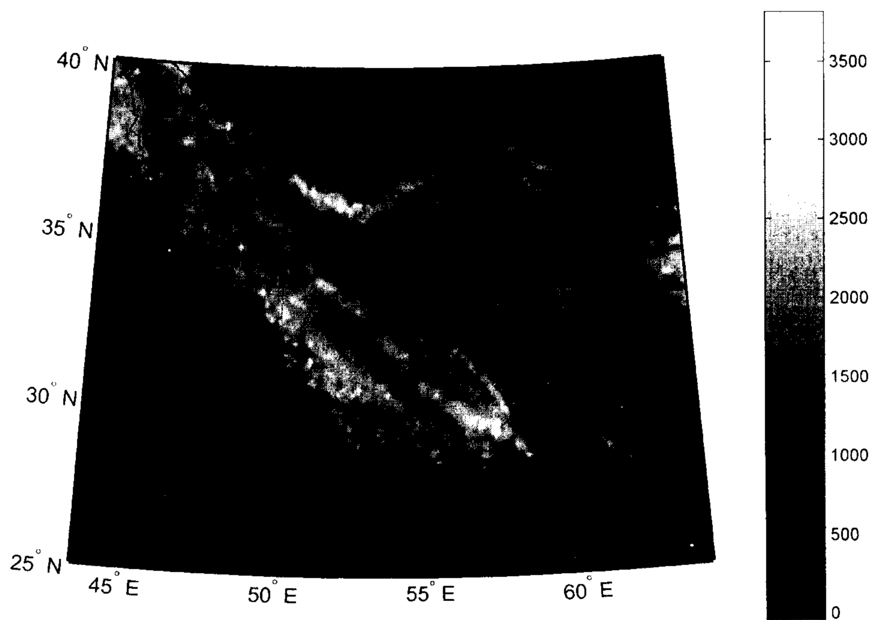
شکل ۱: شبکه DTM ( $30^{\circ} \times 30^{\circ}$ ) محاسبه شده توسط NIMA برای منطقه خشکی های ایران.
