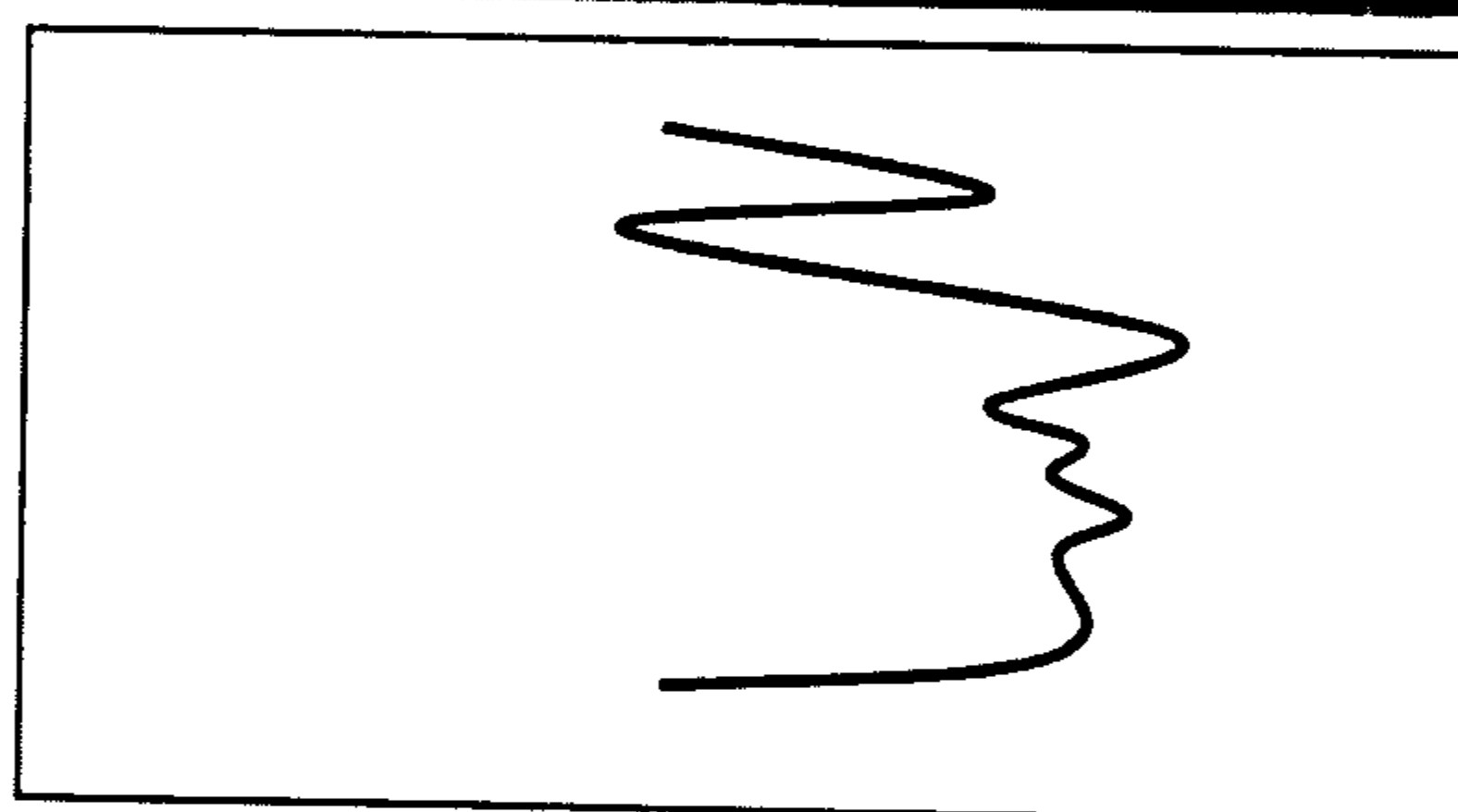
شکل ۹: ورود پلوم آب شیرین به "مخزن درحال پرشدن" با زاویه ۹۰ درجه.
