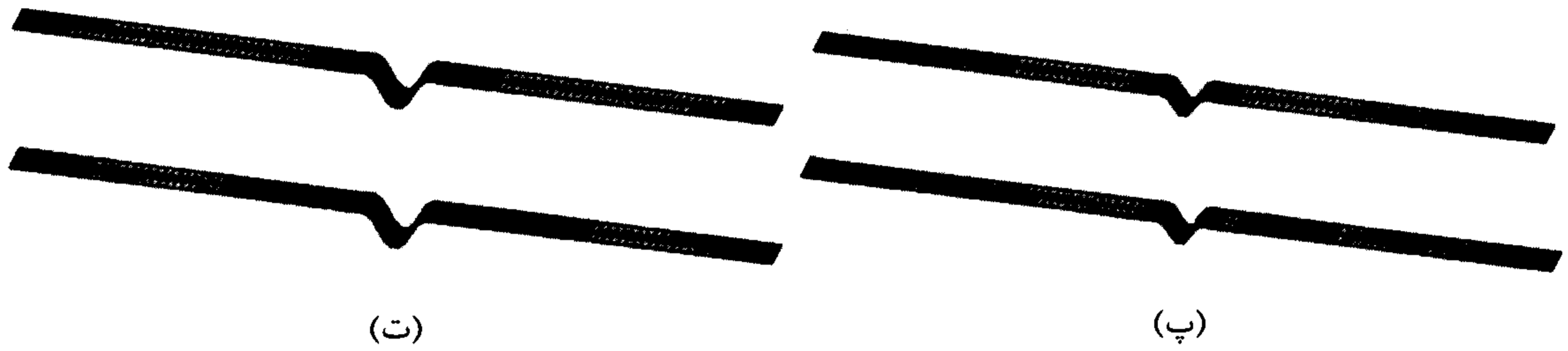
شکل ۱۱: الگوی گسترش ترک خوردگی میان لایه‌ای نمونه نخست در زمانهای: (الف) t = 0.0001 sec، (ب) t = 0.0002 sec، (پ) t = 0.0005 sec و (ت) t = 0.001 sec (جدایی لایه‌ها با رنگ خاکستری، آغاز ترک با رنگ روشن و ناحیه سالم با رنگ سیاه نشان داده شده‌است).
